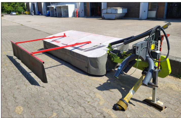
Ein Prototyp eines Mähwerks mit Insektenscheuche, entwickelt am Agrartechnik Institut der Universität Hohenheim (D) im Rahmen des Projekts InsectMow. (Bild: Jonas Frank)
