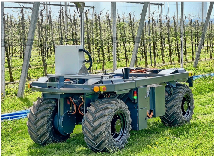
Der Elwobot, ein autonom fahrender Obst- und Weinbauroboter mit modularer Energieversorgung und elektrischem Antrieb, geht jetzt in die Testphase (Bild: LfULG/Hofer)
