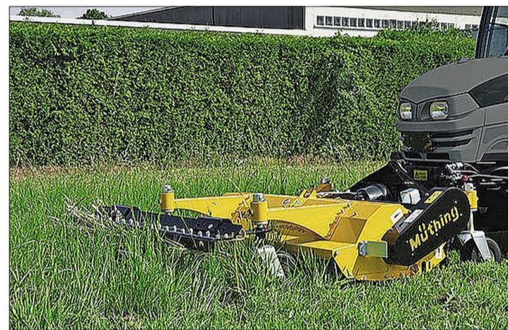
Ein vorgebauter Insektenretter beim MU Ökotop scheucht Lebewesen wie Fliegen, Libellen und Bienen an höhergelegenen Grashalmen auf. (Bild: Mühling)
